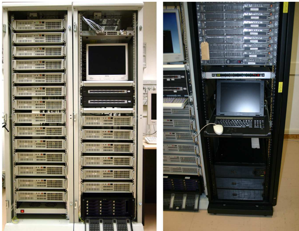
Figura 5.1: Il cluster M.A.N.G.U.S.T.A., sono visibili a destra i nodi a 64 bit e a sinistra i nodi a 32 bit.
